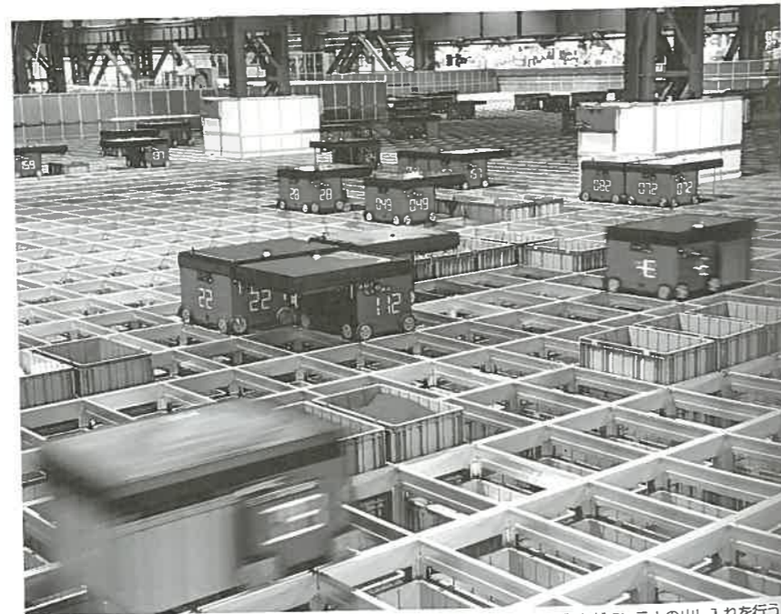
次世代型ロボット自動倉庫「オートストア」。専用コンテナを高密度に収納し、ロボットがコンテナの出し入れを行う
